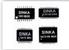
网路变压器 Lan Transformer
