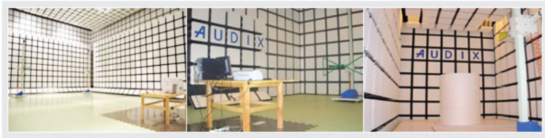
辐射干扰测试实验室 (10米法半电波暗室) 10m Semi-Anechoic Chamber
